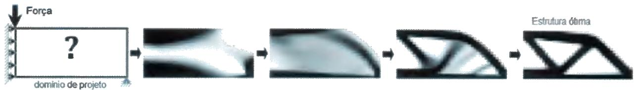
**Figura 12** - Exemplo de aplicação do MOT, mostrando o processo iterativo de otimização.
