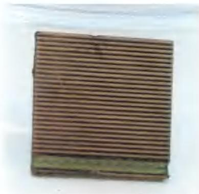
**Figura 64** – Molde em FR4 fabricado a laser, com largura aproximada dos canais de 70 micrometros.
