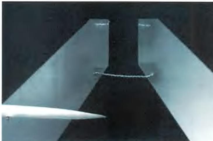
**Figura 2** – Caracterização de uma nanomola no interior de um MEV (FEMTOTOOLS, 2014).
