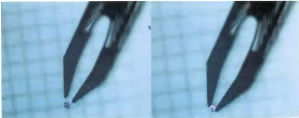
**Figura 54** - Manipulação de uma esfera de rubi de 150  $\mu\text{m}$  de diâmetro pela micropinça PEIXE.
