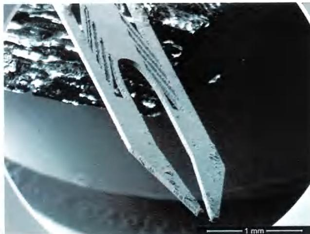
**Figura 38** - Ponta da micropinça PEIXE. Imagem obtida através de microscopia eletrônica.
