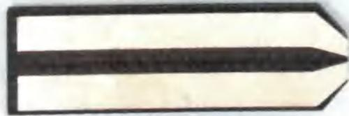
**Figura 22** - PCI de *FR4* usinada na máquina da *LPKF* para uma micropinça *W*, mostrando as trilhas de cobre.
