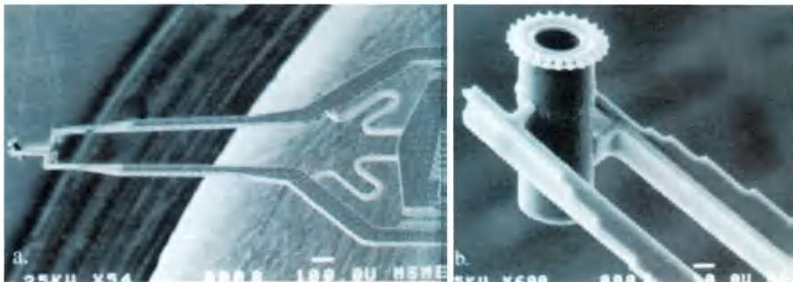
**Figura 5** - Imagens em MEV de micropinças de silício policristalino manipulando uma engrenagem também de silício policristalino (KELLER, 1998).
