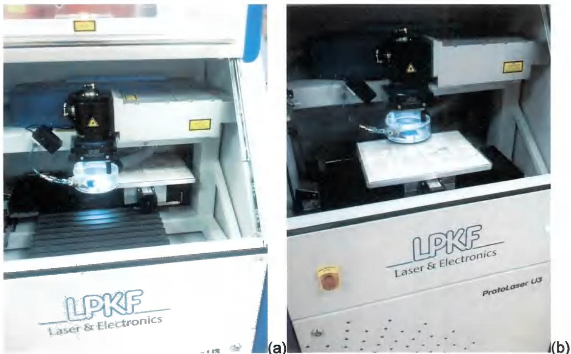
**Figura 16** – (a) Posição da mesa após equipamento ser referenciado. (b) Posição da mesa para colocar peça a ser usinada.
