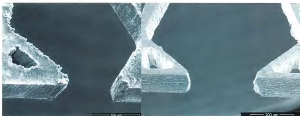
**Figura 35** - a) Imagem da ponta após a microusinagem a laser; b) imagem da ponta após o eletropolimento.
