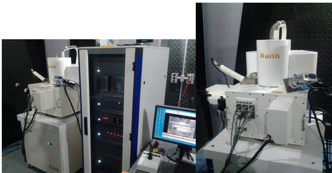
Figura 9: Imagens do sistema de Nanolitografia por feixe de elétrons NANOLITO que compõe o rol de equipamentos multiusuários do LABNANO. Fonte: fotos capturadas pelos servidores quando da visita técnica realizada em dezembro de 2015.
