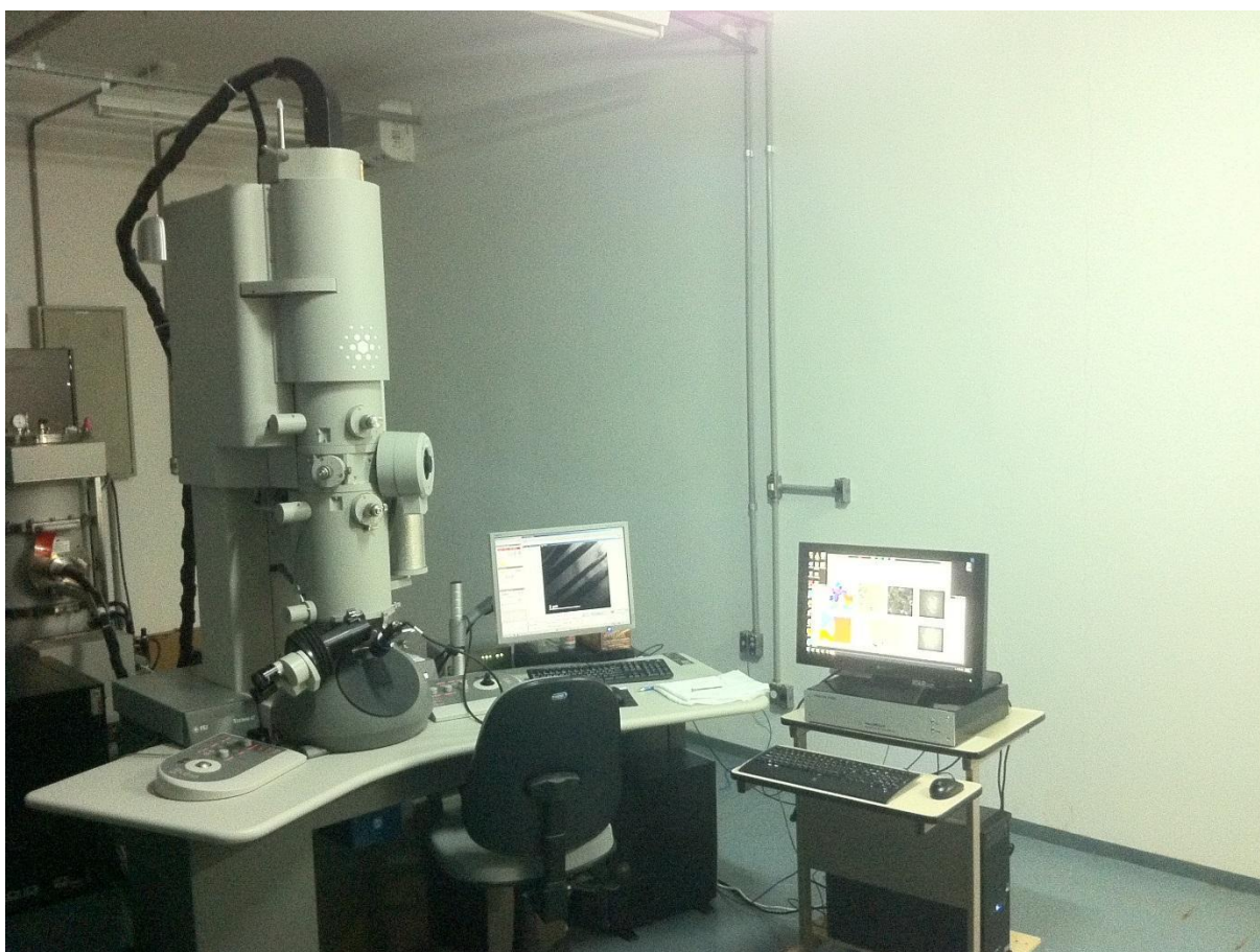
Figura 29: Microscópio Eletrônico de Transmissão (MET) TECNAI 20 Spirit S-TWIN, adquirido com recursos do SisNANO e que está disponível para usuários externos. Fonte: foto capturada pelos servidores quando da visita técnica realizada em dezembro de 2015.
