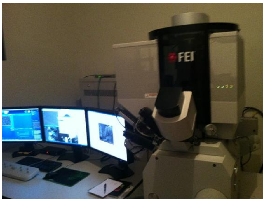
Figura 28: Microscópio de Feixe Duplo (FIB – Focused Ion Beam) e que está disponível para usuários externos. Fonte: foto capturada pelos servidores quando da visita técnica realizada em dezembro de 2015.
