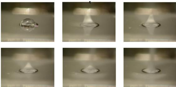
Sequência do processo de deposição a partir de uma gotícula (volume < 1 microlitro) de suspensão de baixa densidade, gradualmente transformando o líquido em jato de vapor a ser depositado.
