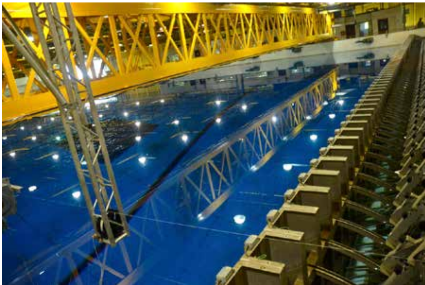
Figura 1: Gerador de ondas do LabOceano da COPPE/UFRJ
