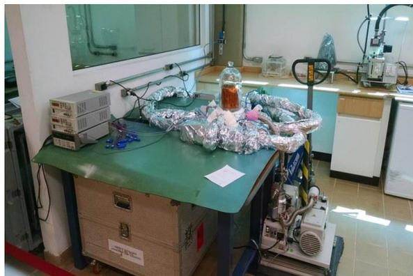
Um dispositivo capaz de verificar a propriedade de condutância térmica de novos materiais, abrindo, assim, a possibilidade de usar dados mais precisos em modelamentos computacionais de controle térmico de satélites, foi o equipamento desenvolvido pela Equatorial Sistemas, umas das seis empresas selecionadas para participar do plano de absorção e transferência das tecnologias do Satélite Geoestacionário de Defesa e Comunicações (SGDC).
