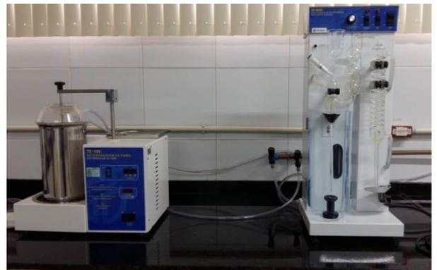
Determinador de fibras em detergente Neutro/Ácido e Destilador de Nitrogênio
