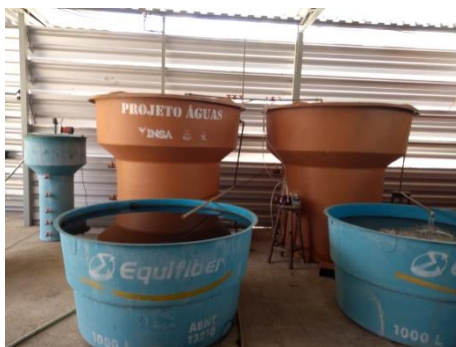
Foto dos Reatores UASB (a) recebe esgoto municipal; (b) recebe esgoto condominial.
