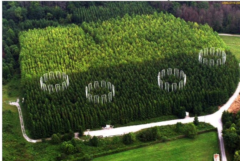
Figura 13: Tecnologia FACE aplicada a uma floresta temperada (Oak Ridge National Laboratory, EUA)
