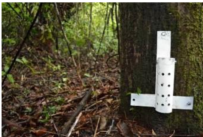
Figura 9: projeto coordenado pelo Dr. Hélder de Queiroz – instalação de sensores para análise do regime de alagamento.
