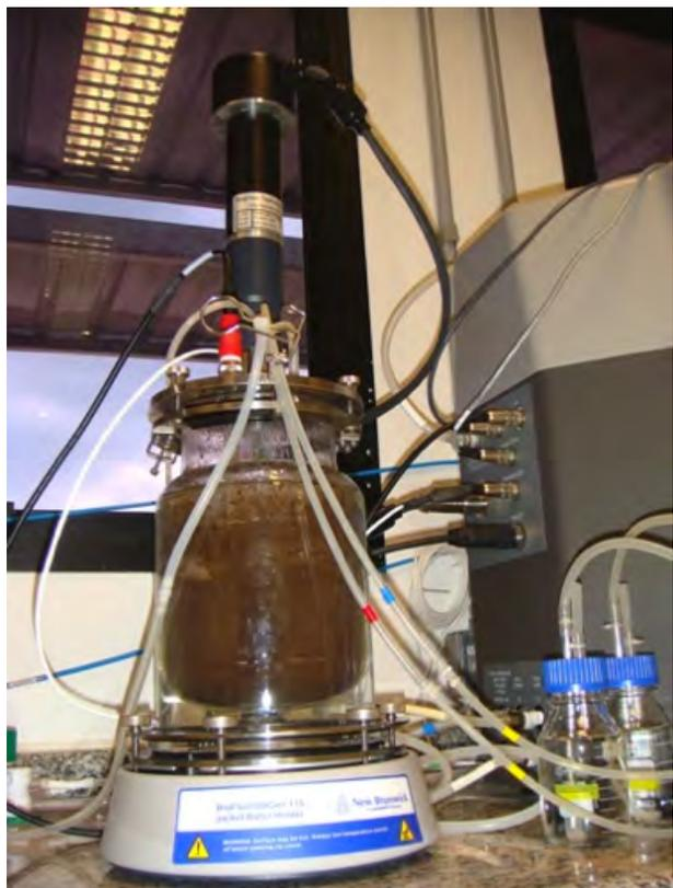
Figura 34 - Hidrólise Enzimática em laboratório
