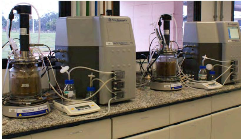
Figura 32 - Fermentação para produção de enzimas em laboratório
