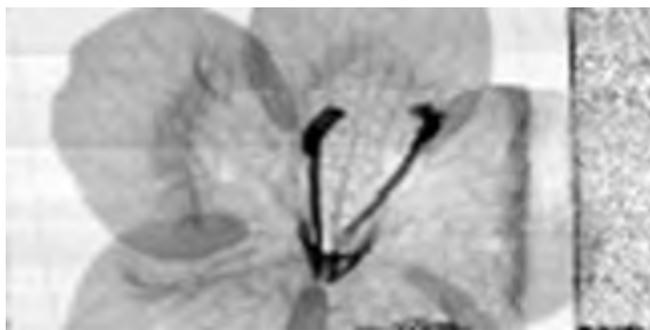
Figura 7 - Radiografia de uma flor obtida com o uso das três grades de difração para 14 keV na Linha XRD-2
