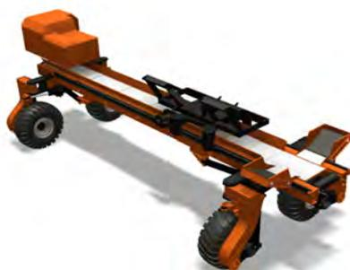
Figura 28 - Estrutura e pernas mecânicas da ETC
