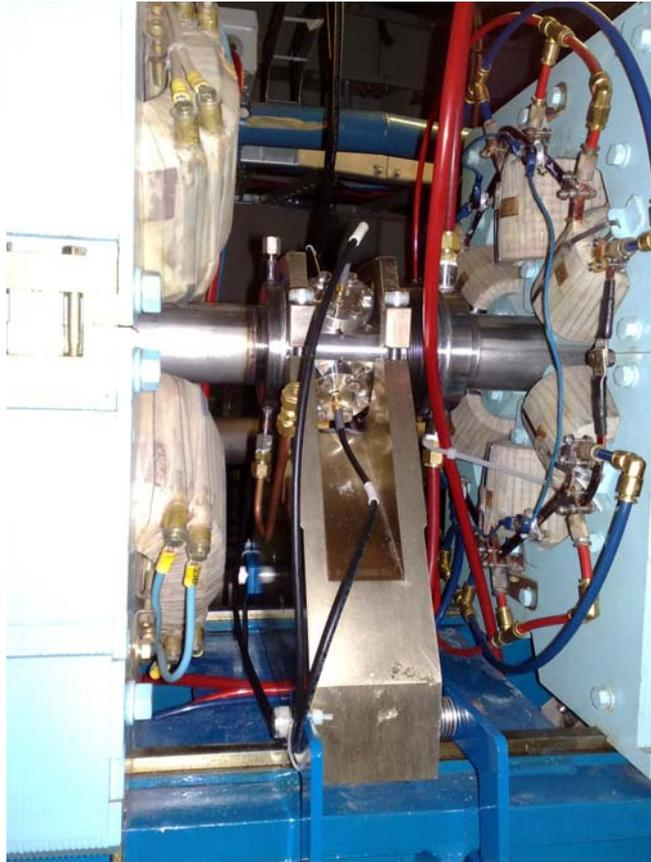
**Figura 1:** Monitor de posição instalado no anel de armazenamento. No corpo do monitor destaque para a máscara refrigerada (à esquerda) e para o trecho de câmara flexível (bellows, à esquerda). O suporte de latão-manganês fixa rigidamente o monitor ao berço de ímãs.
