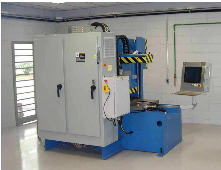
**Figura 6: Máquina de solda por fricção a pino**
