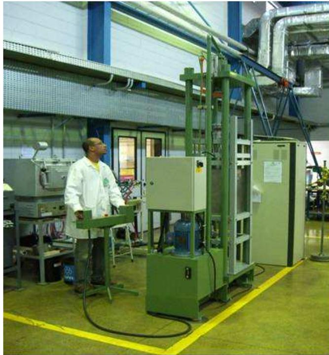
**Figura 7: Prensa e forno para desenvolvimento de Telas Premium**
