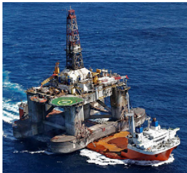
Figura 6a – Uma sonda semissubmersíveis sendo transportada por um HLV (MAF, 2009).
