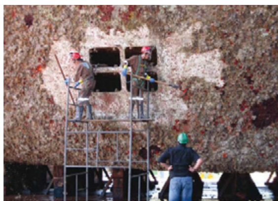
Figura 4 – Remoção manual em embarcação mantida em dique-seco.
