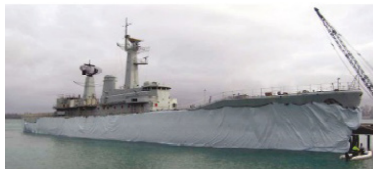
Figura 22 – Fragata “the Canterbury” encapsulada com lona plástica na Nova Zelândia
