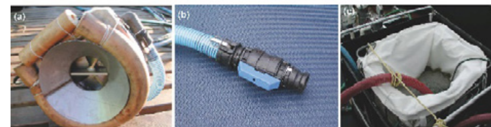
Figura 17 - Sistemas subaquáticos de aspiração a vácuo para remoção de Didemnum vexillum .
