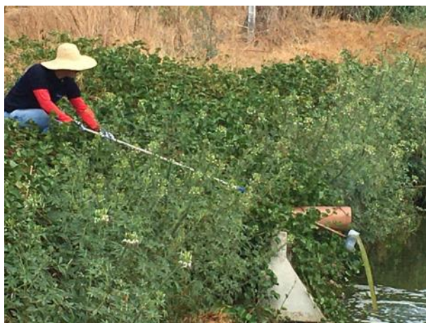
Coleta realizada na entrada da primeira lagoa de maturação da ETE de São Fernando (RN).
