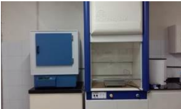
Estufa com circulação de ar forçado e Capela para exaustão de gases
